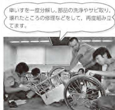
車いすを一度分解し、部品の洗浄やサビ取り、壊れたところの修理などをして、再度組み立てます。
