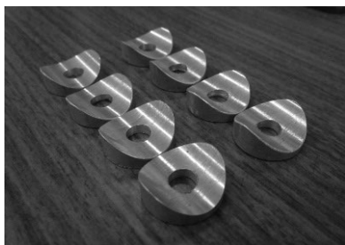
変形した部品(上)と自作した部品(下)
